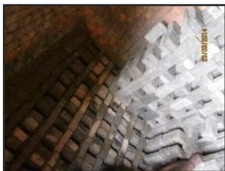
Disposition de cargaison des briques verts pour et aspect de la chambre à cuisson terminée →
