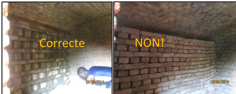
Disposition de cargaison des briques verts pour le mur de soutènement
