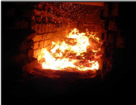
Allumage du four avec du bois de chauffage dans le bouches de la 1 chambre
