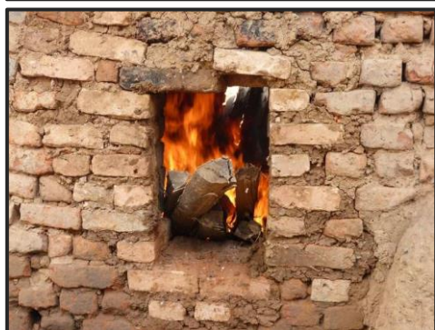
Allumage du four avec du bois de chauffage dans le bouches de la 1 chambre
